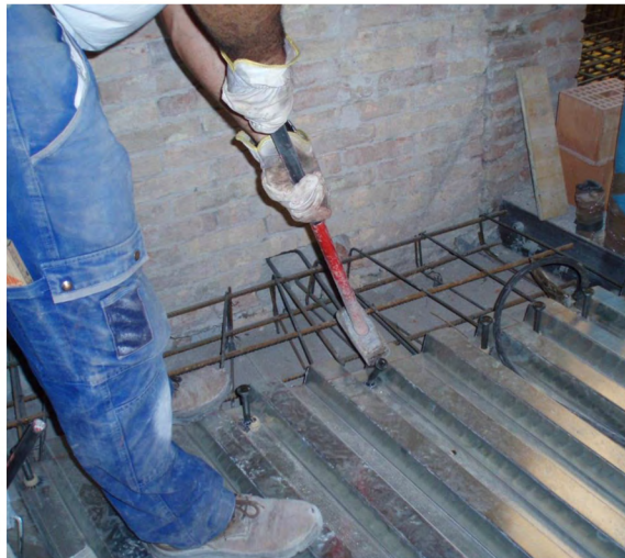
Prova a strappo connettori Nelson
